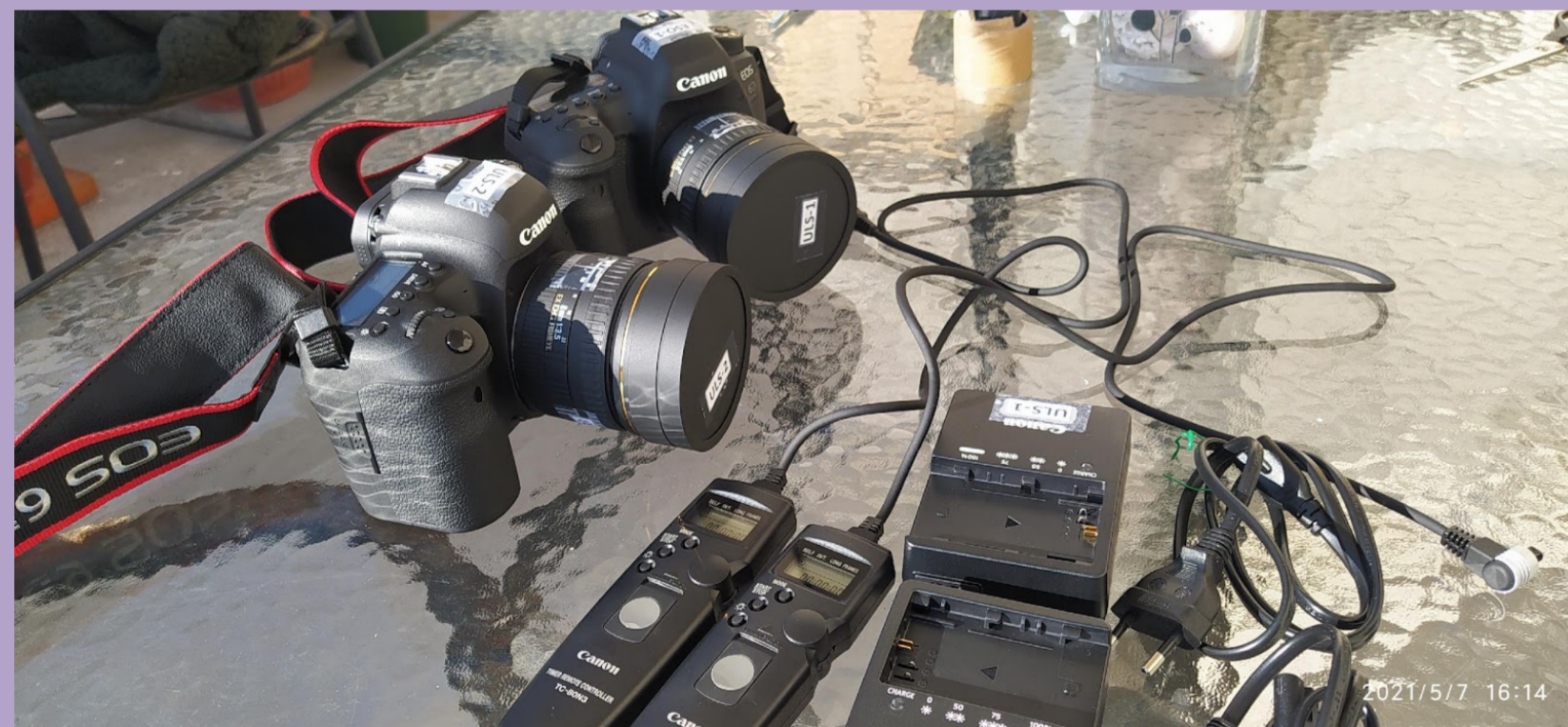
Figura 1: Cámaras SQC ULS-1 y ULS-2 utilizadas para monitorear y caracterizar la calidad del cielo nocturno en el sitio de interés.
